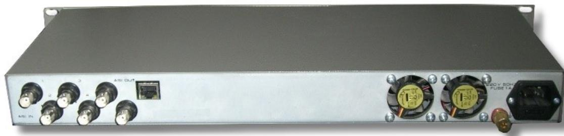
Управление Ремультиплексором осуществляется от ПК , который подключается по сети Ethernet к разъему RJ45 на задней панели. Этот же разъем используется и для IP выхода.
